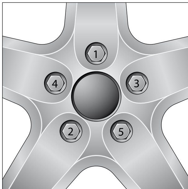
Abb. 92 Radmuttern über Kreuz festziehen
