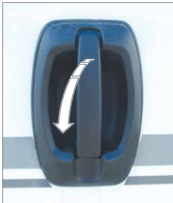
Abb. 17 Schiebetür von außen öffnen und schließen
